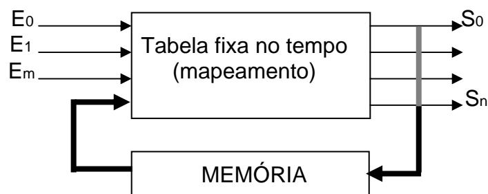
Figura 2.6 Um sistema de lógica sequencial é constituído por um bloco de lógica combinacional com alguns estados lógicos realimentados à entrada através de um bloco de memória.
