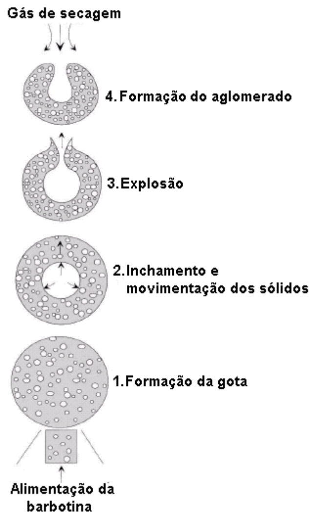
Figura 4.8 Etapas da secagem e granulação de suspensões cerâmicas em spray-dryer 23
