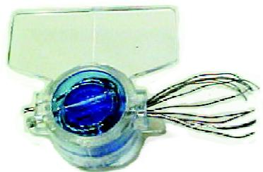
**Figura 2.7:** Lacre rompido para equipamento de ECF
