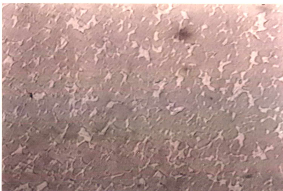
Fig. 42. Micrografia da amostra 90%WC (2,5 \mu m) + 10% (97%Ni +3%Al), sinterizada sob alto vácuo a 1460 ^{\circ} C durante 1 hora. Aumento de 1600 X e ataque com reativo de Murakami.
