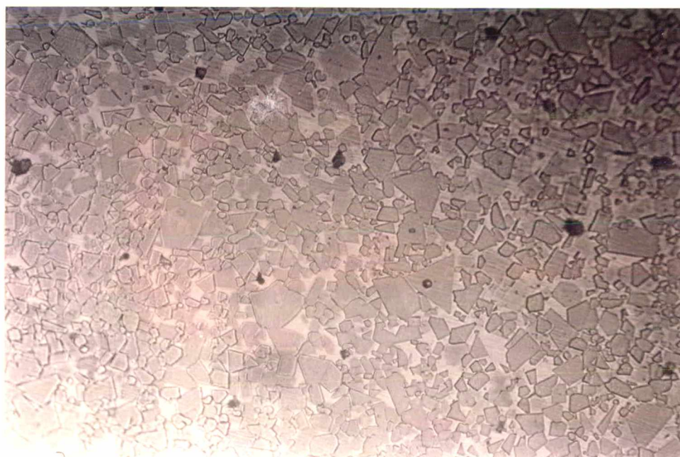
Fig. 52. Micrografia da amostra 86,35% WC ( 5\mu\text{m} ) + 13,65% (90% Ni + 7% Si + 2,99% C), sinterizada sob alto vácuo a 1600^{\circ}\text{C} durante 1 hora. Aumento de 2400 X e relativo de Murakami.
