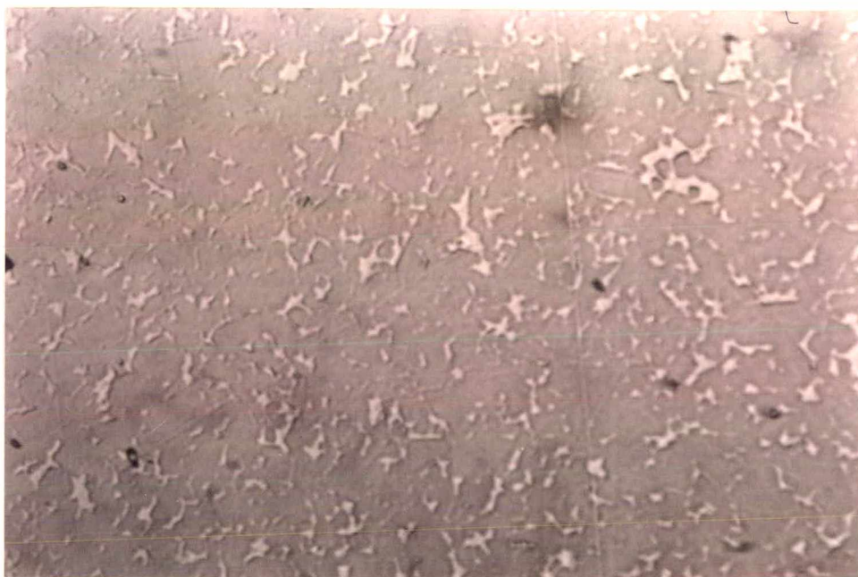
Fig. 44. Micrografia da amostra com 89,98% WC (2,5 \mu m) + 10% (95%Ni+5%Al) + 0,02%C, sinterizada sob alto vácuo, a 1460 o C durante 1 hora. Aumento de 1600 X e reativo de Murakami.
