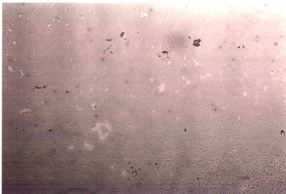
Fig. 57. Micrografia da amostra com 94% WC (2,5 \mu\text{m} ) + 6% (95,9% Ni + 4,1% Si), sinterizada a 1470 o C sob alto vácuo, durante 1 hora. Aumento de 800X e reativo de Murakami.
