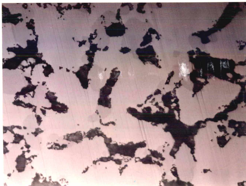
Fig. 35. Micrografias feitas no resíduo poroso após a "infiltração". (a) microscopia eletrônica, foto de composição, mostrando a cintilografia de áreas ricas em Al; (b) poros excessivos no resíduo. Aumento de 100 X (a) e 1250 X (b) (aparecimento de duas fases). Reagente nital a 4%.
