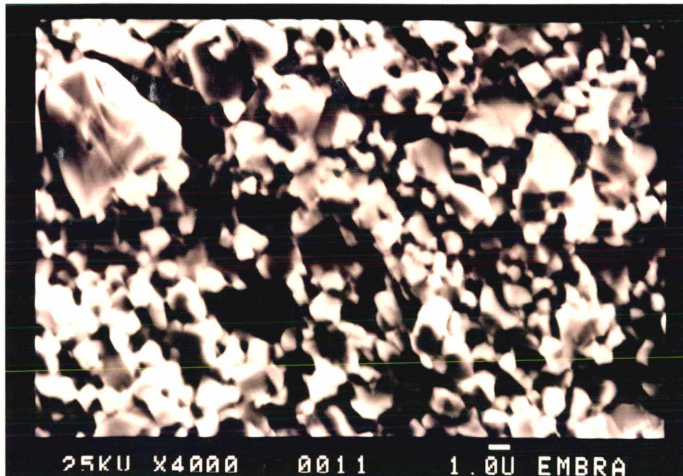
Fig. 59. Fractografia da amostra contendo 6% de ligante à base de Ni com 4,1% de Si. Aumento de 4000 X.
