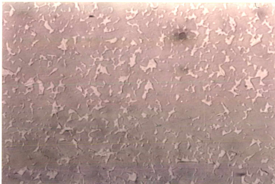
Fig. 63. Micrografia da amostra 90% WC( 2,5\mu\text{m} ) + 10% (94%Ni + 3%Si + 3% Al), sinterizada sob alto vácuo a 1460^\circ\text{C} , durante 1 hora. Aumento de 1600 X e reativo de Murakami.
