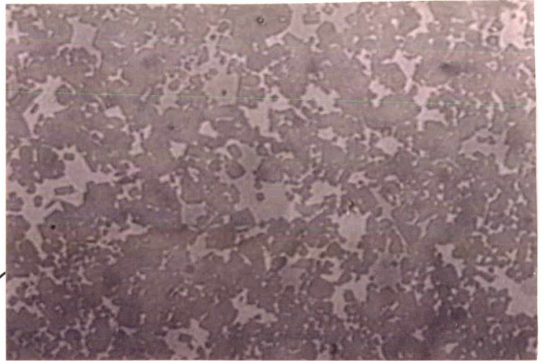
Fig. 32. Micrografia da parte densa da amostra "infiltrada", acima da linha média M . Aumento de 1250 X. Reagente de Murakami.
