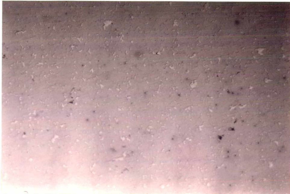
Fig. 58. Micrografia da amostra com 92% WC ( 2,5\mu\text{m} ) + 8% (95,9% Ni + 4,1% Si), sinterizada a 1470^{\circ}\text{C} sob alto vácuo, durante 1 hora. Aumento 800 X e reativo de Murakami.
