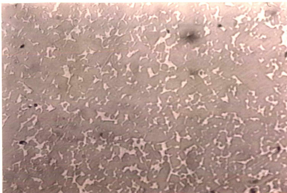
Fig. 43. Micrografia da amostra 90%WC (2,5 \mu m) + 10%(95%Ni + 5%Al), sinterizada sob alto vácuo a 1460 o C, durante 1 hora. Aumento de 1600 X e reativo de Murakami.
