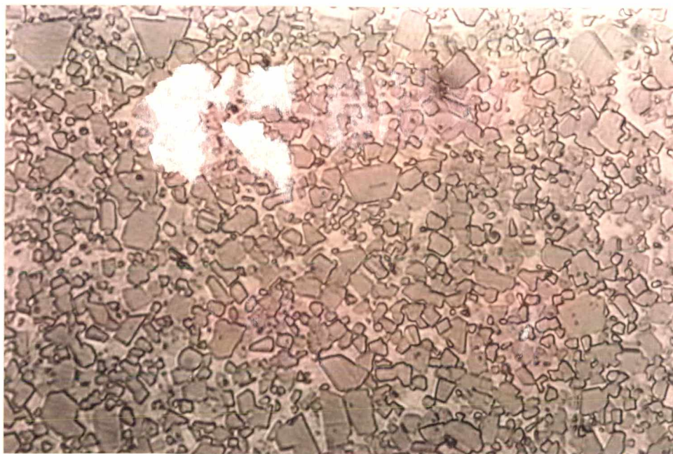
Fig. 50. Micrografia da amostra 86,35% WC ( 2,5 \mu\text{m} ) + 13,65% (93,83% Ni + 4,32% Si + 1,84% C), sinterizada sob alto vácuo a 1460^\circ\text{C} durante 1 hora. Aumento de 2400 X e reativo de Murakami.
