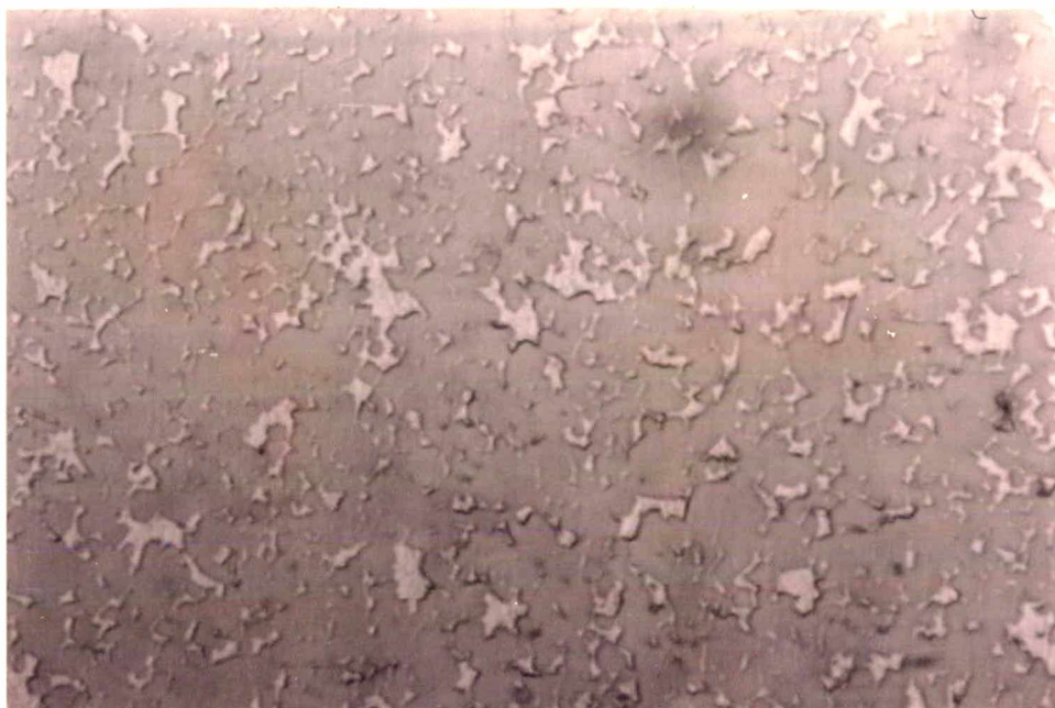
Fig. 49. Micrografia da amostra 86,35% WC ( 2,5 \mu\text{m} ) + 13,65% (95,23% Ni + 3,33% Si + 1,43% C), sinterizada sob alto vácuo a 1460^\circ\text{C} durante 1 hora. Aumento de 2000 X e reativo de Murakami.
