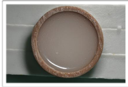
Fig.9-10 - Inclusão dos espécimes em resina epóxica.
