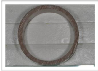
Fig.7 - Fita adesiva e tubo plástico posicionados para inclusão dos espécimes
