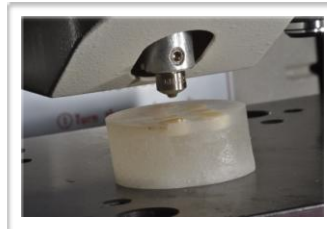
Fig.16-17 - Execução do teste de microdureza Vickers
