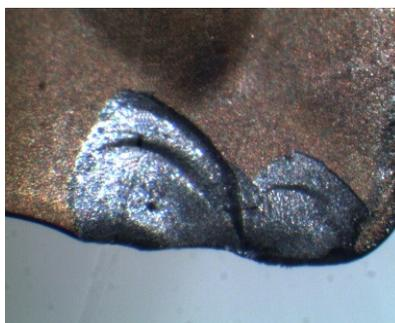
Figura 51. Lascamento do inserto da ferramenta de 10 mm (classe P30)
