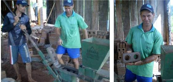
Figura 6: Fabricação de BTC em prensa manual. Acervo da autora.
