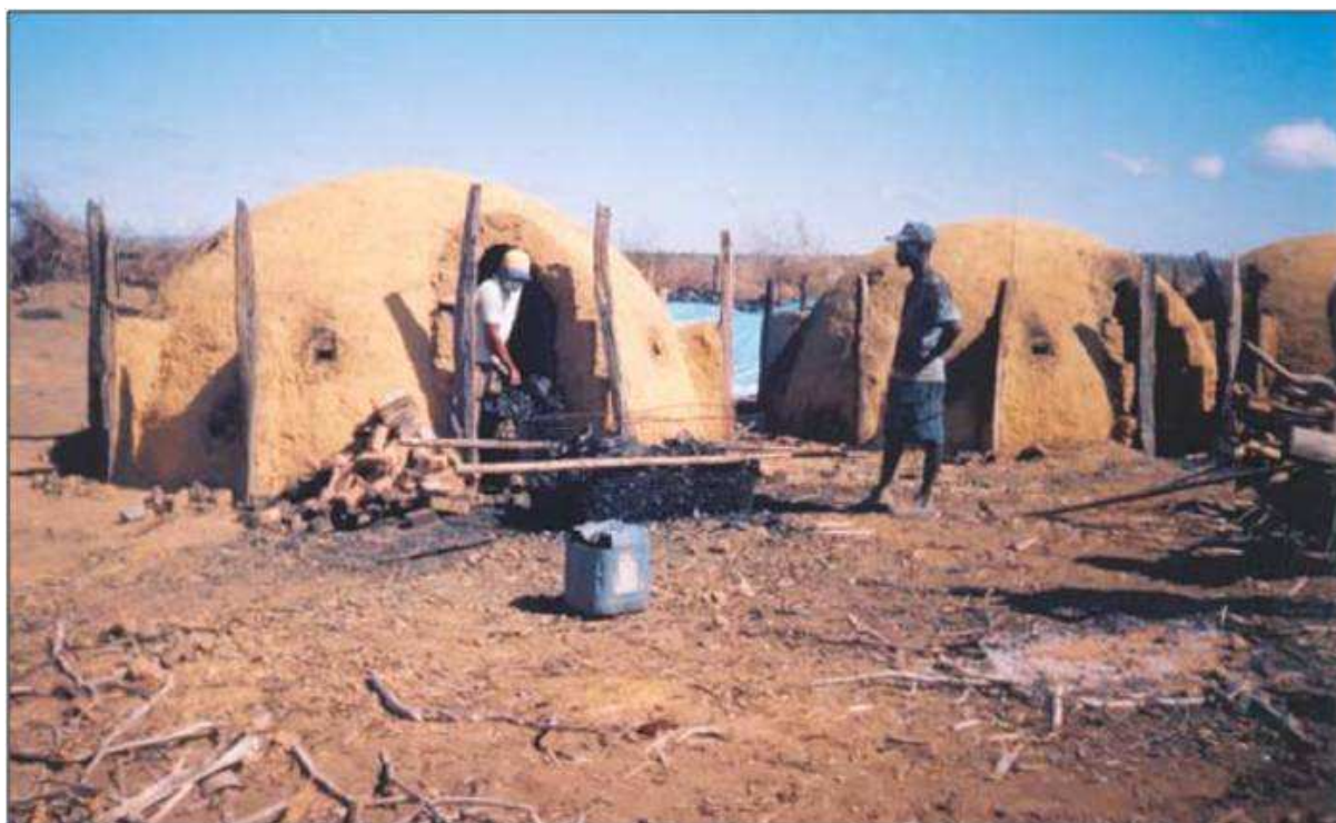
Figura 35: Carvoaria utilizando madeira de eucalipto não aproveitada pela empresa.
