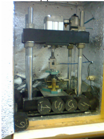
Figura 12 – Determinação do MR no equipamento do laboratório da UFSC
