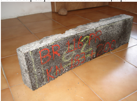
Figura 30 – Placa extraída da pista para o ensaio de deformação permanente
