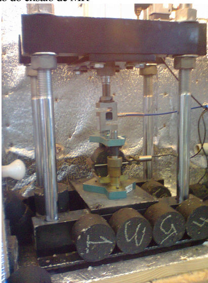
Figura 29 – Realização do ensaio de MR
