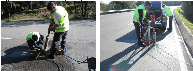
Figura 28 – Extração de corpos de prova em campo
