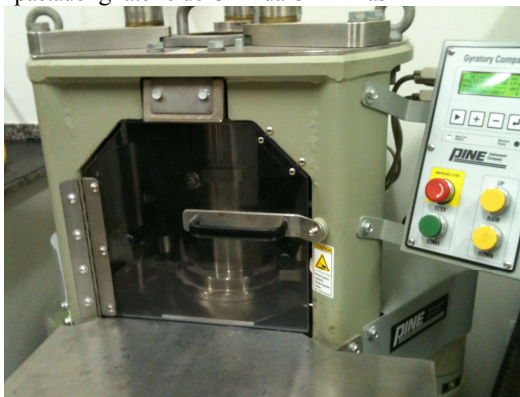
Figura 22 – Compactador giratório do CDT da OHL Brasil
