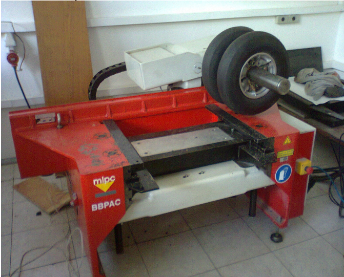
Figura 13 – Mesa Compactadora LCPC
