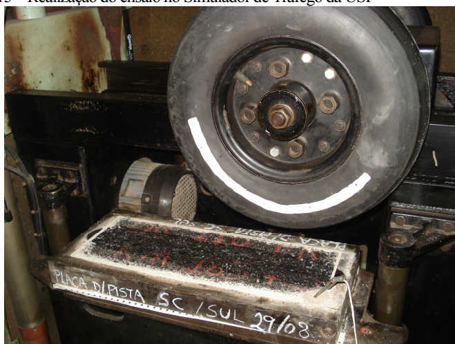
Figura 15 – Realização do ensaio no Simulador de Tráfego da USP
