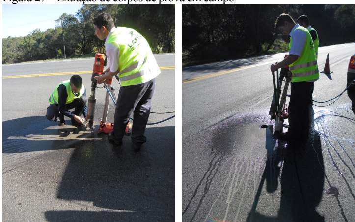
Figura 27 – Extração de corpos de prova em campo
