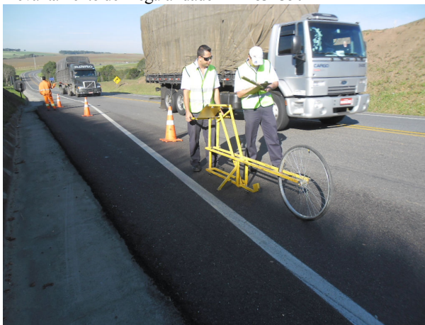
Figura 49 – Levantamento de irregularidade km 183+350
