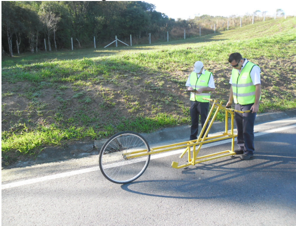
Figura 50 – Levantamento de irregularidade km 183+500
