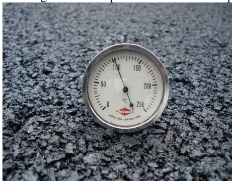
Figura 44 – Termômetro registrando a temperatura da massa na compactação
