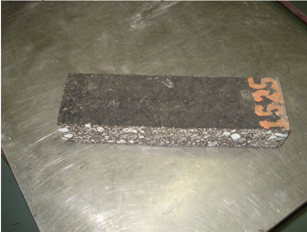
Figura 16 – Placa após ensaio de deformação permanente
