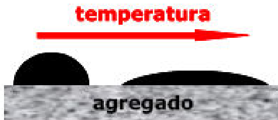
Figura 8 – Recobrimento do agregado pelo ligante asfáltico em relação a elevação de temperatura (MOTTA, 2011).
