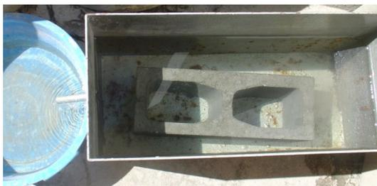
Figura 12: Ensaio de absorção dos blocos.
