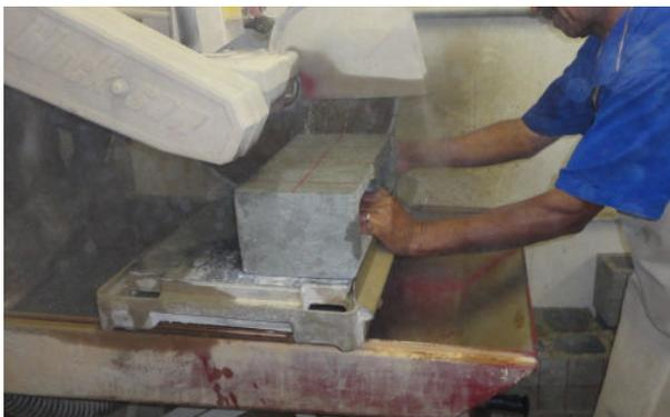
Figura 22: Seccionamento do bloco para preparação das peças (fatias) dos mini-prismas.
