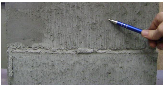
Figura 85: Prisma com ruptura por esmagamento da junta.
