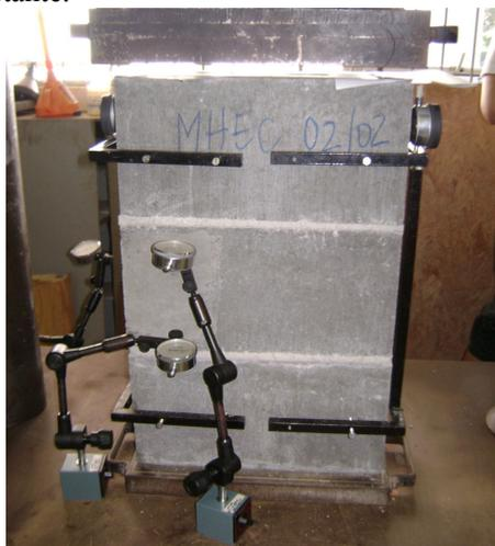
Figura 30: Instrumentação dos prismas de três fiadas.
