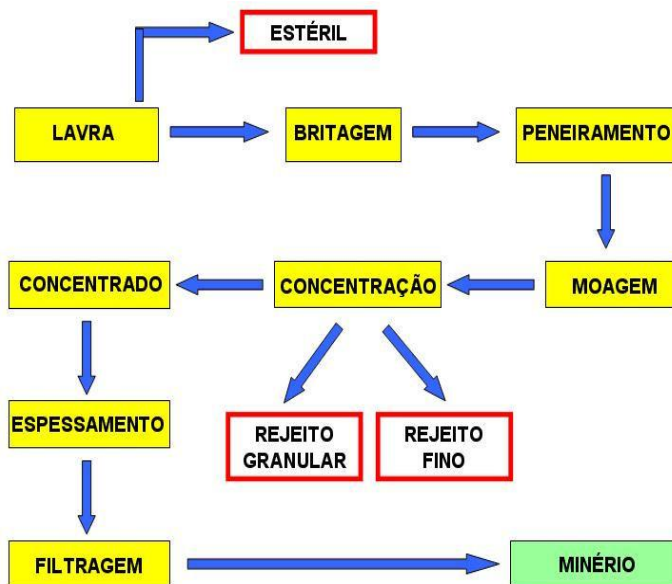
Figura 2 - Esquema típico do processo de mineração de ferro. 1. (FONTE: SILVA, 2010).
