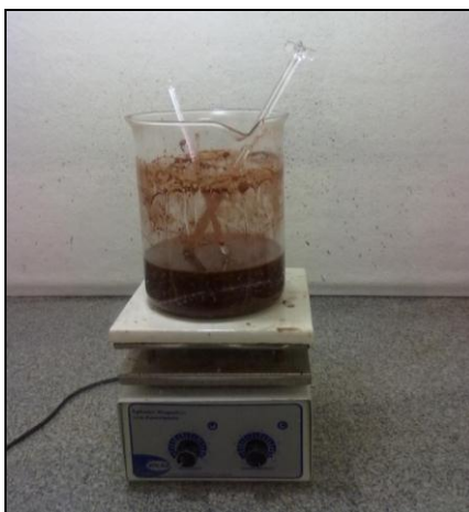
Figura 12 - Processo de obtenção de sulfato ferroso (etapa de redução do Fe +3 à Fe +2 ).
