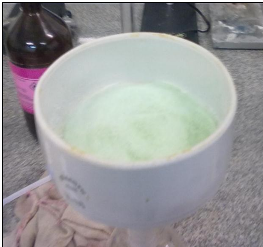
Figura 14 - Cristais de sulfato ferroso retidos no papel filtro.
