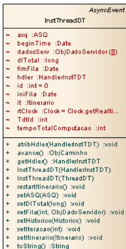
Figura 13 – Diagrama da implementação do Segmento Local
