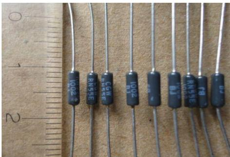
Figura 33 - Resistores de elevada precisão para o divisor resistivo.
