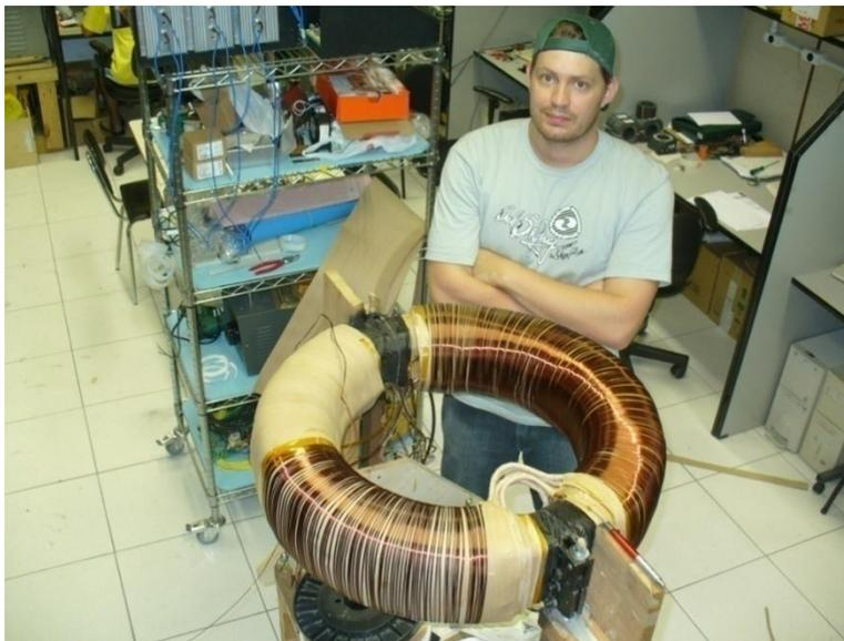
Figura 101 – Manufatura do transformador elevador toroidal.
