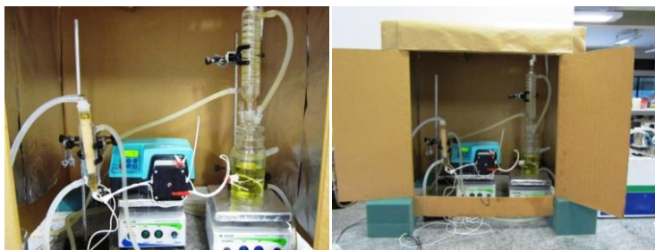
Figura 0.1- Aparato experimental utilizado nos ensaios de produção de biodiesel etanólico de óleo de palma em modo contínuo.
