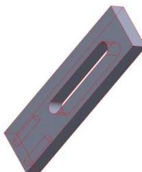
Figura 3.3 - Suporte da garra da bobina
