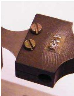
Figura 3.15 - Detalhe da fixação do corpo de prova
