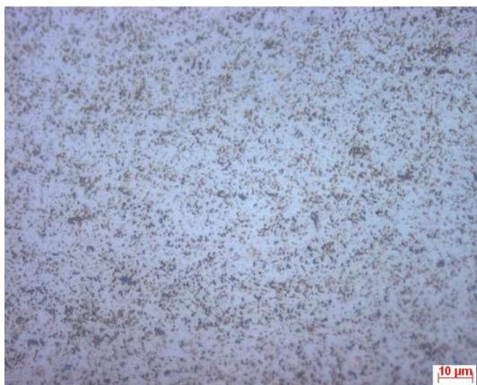
Figura D.0.1 – Microestrutura da secção transversal da amostra de aço inox. Ataque Nital 4%. Aumento 1000x.
