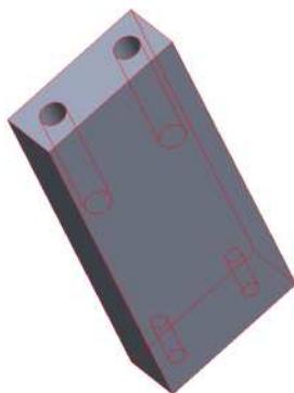
Figura 3.5 - Suporte da célula de carga
