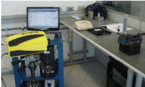
Figura 5.1 Montagem da bancada para análise modal experimental
