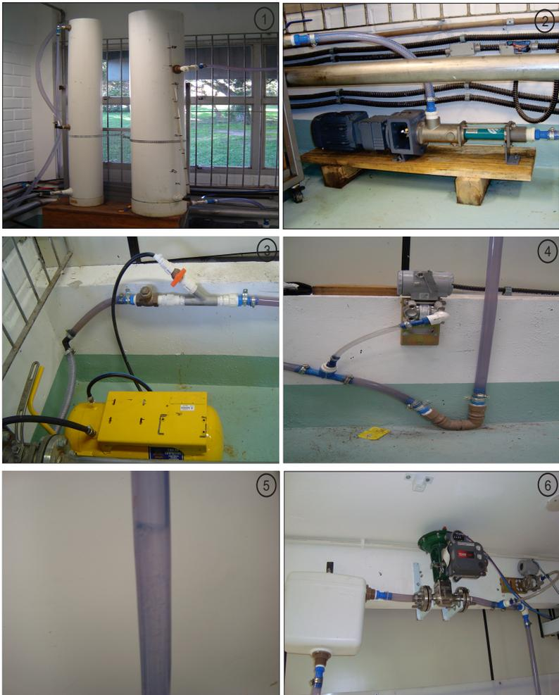
**Figura 5.2:** Imagens da planta experimental. 1 - Reservatório de água. 2 - Bomba rotativa de deslocamento positivo. 3 - Reservatório de ar comprimido e ponto onde ocorre a mistura dos fluidos (água e ar) que entram na *flowline*. 4 - Ponto baixo do *riser*. 5 - *Riser*. 6 - Topo do *riser* onde localizam-se a válvula de controle, transmissor de pressão e separador água/ar.
