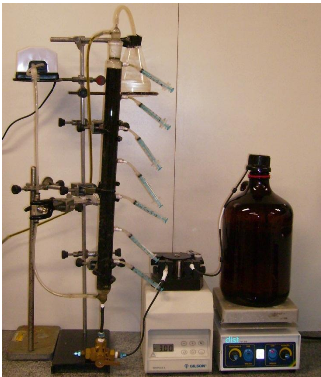
Figura 5.4 – Aparato experimental do processo de biodegradação dos compostos BTX em coluna.
