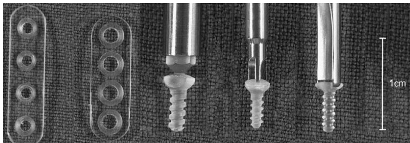
Figura 5 – Placas e parafusos bioabsorvíveis utilizados em aplicações bucomaxilofaciais (WITTEWERT et al. , 2005).
