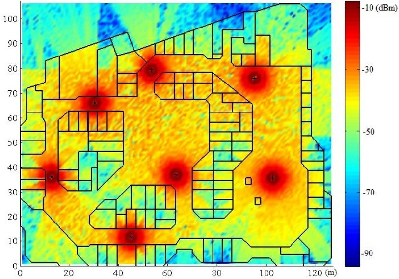
Figura 4.14 – Mapeamento dos campos para a frequência de 900 MHz.
