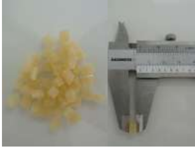
Figura 17 – Corte do gel em cubos e verificação do tamanho da aresta.
