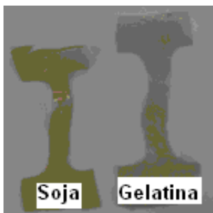
Figura 7 – Inchamento de amostras de gel de proteína de soja e gelatina após a imersão em água.
