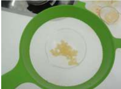
Figura 18 – Lavagem do gel com água destilada após o corte dos cubos.
