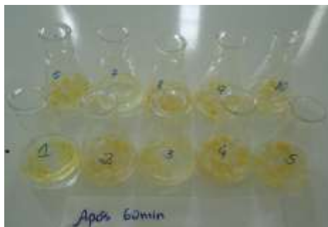
Figura 21 – Aspecto dos cubos após 60 minutos em condições controladas para determinação da migração.
