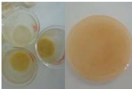
Figura 16 – Aspecto do gel de gelatina e plastificante após o resfriamento.
