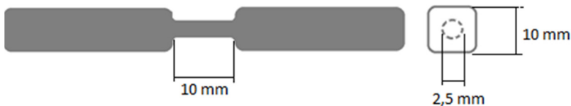
Figura 3-7 - Esquema do corpo de prova utilizado para os testes de fluência cíclica.
