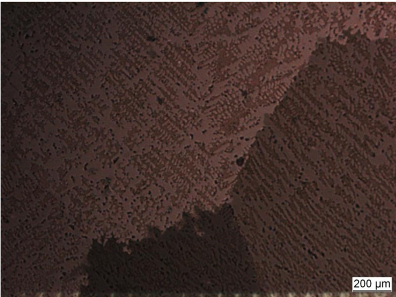
Figura 4-7 – Micrografia óptica da liga SnAg3,5In2 utilizando luz polarizada.
