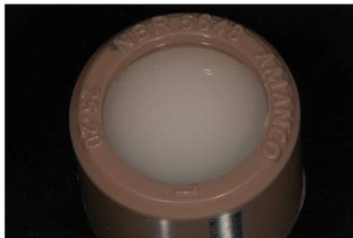
**Figura 5: Suporte de PVC preenchido por resina acrílica.**
