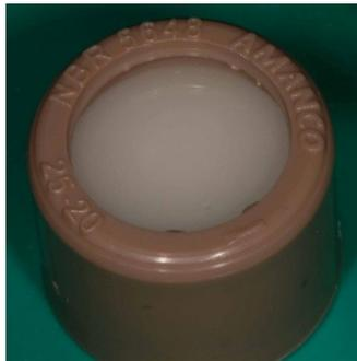
**Figura 34. Preenchimento do suporte com resina acrílica.**
