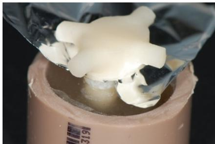
**Figura 21: Posicionamento da folha de alumínio para mensuração da área de adesão.**
