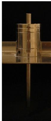
**Figura 30: dispositivo para padronizar a força de cimentação.**
