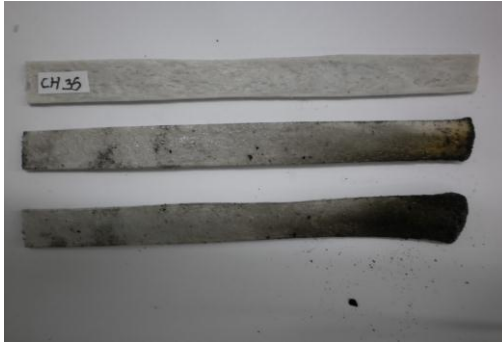
Figura 5.12 - Ensaio para classificação UL94 no corpo de prova CH35.
