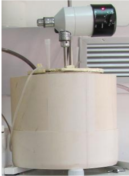
Figura 17- Reator nitritante utilizado no trabalho
