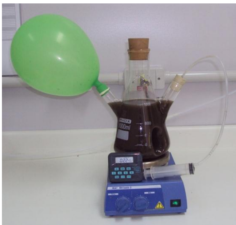
Figura 20 - Reator utilizado nos ensaios cinéticos de desnitrificação.
