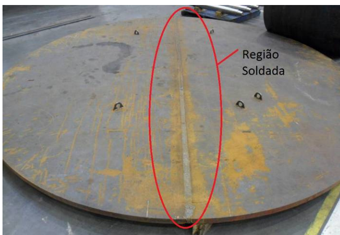
Figura 3 – Obtenção de disco de 4000 mm de diâmetros a partir de chapas soldadas.
