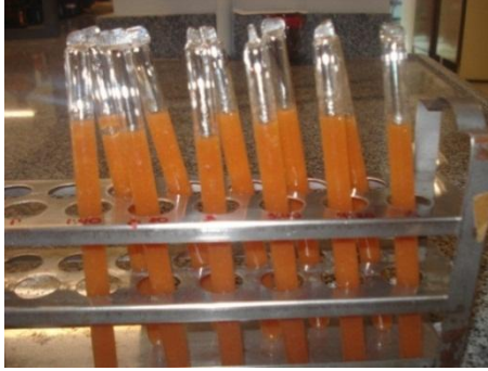
Figura 3.1. Ilustração de tubos TDT preenchidos com polpa de tomate inoculada e selados
