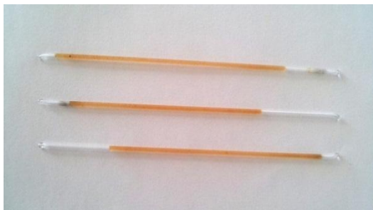
Figura 3.2. Ilustração de tubos capilares preenchidos com polpa de tomate inoculada e selados
