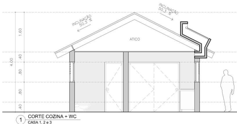
Figura 55. Conexão da chaminé com cozinha das Casas 1, 2 e 3
