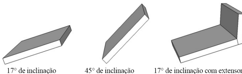
Figura 20. Variação no ângulo de inclinação da chaminé. Fonte: NEVES; RORIZ (2011)
