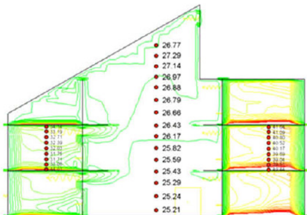
Figura 12. Distribuição de temperaturas com valor de temperatura ambiente de 25°C. Fonte: LIU; LIN; CHOU (2009)
