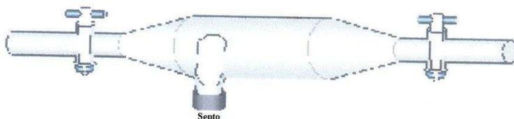
Figura 18: Ampola utilizada na coleta dos gases
