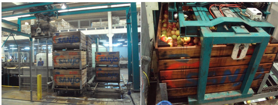
Figura 8. Sistema automatizado de carregamento e descarregamento dos bins (Robôs) na pré-classificação das maçãs. Foto: Tatiane C. da Silva, 2012.
