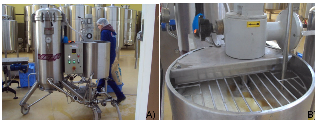
Figura 21. Filtro vertical Velo, vista frontal (A) e vista superior do reservatório (B).
