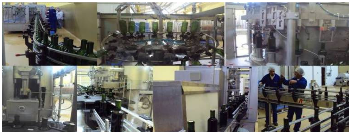
Figura 33. Funcionamento da Máquina envasadora ARBRAS no envase do vinho Nobrese. Fonte: Tatiane C. da Silva, 2012.
