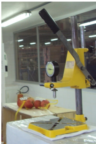
Figura 14. Penetrômetro utilizado para medida de firmeza de polpa (lbs). Fonte: Tatiane C. da Silva, 2012.
