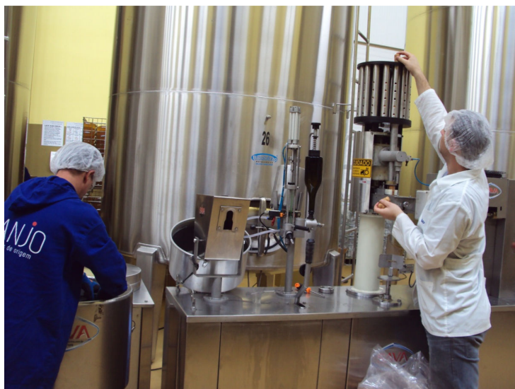
Figura 34. Máquina degorjadora utilizada para espumantes produzidos pelo método champenoise . Fonte: Tatiane C. da Silva, 2012.
