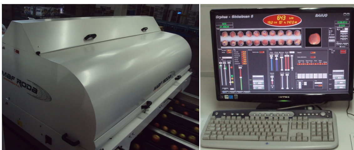
Figura 6. Vista externa da câmara de leitura óptica (esquerda) e computador mostrando o programa de classificação (direita), utilizados na pré-classificação das maçãs. Foto: Tatiane C. da Silva, 2012.
