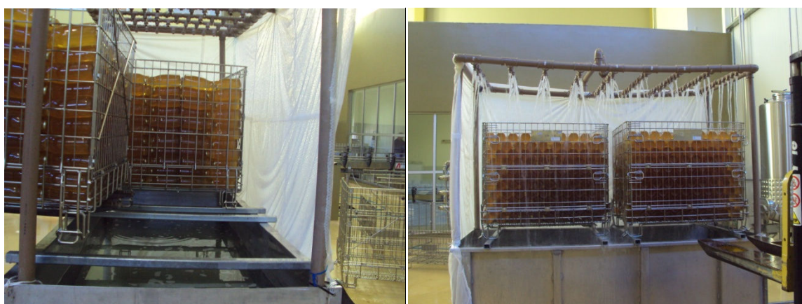
Figura 24. Choque térmico com água fria nas garrafas após o envase. Foto: Tatiane C. da Silva, 2012.
