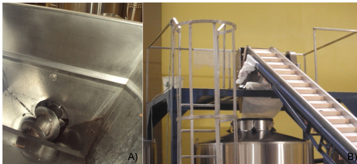
Figura 30. Esmagamento das bagas (A) na entrada no tanque fermentação (B).
