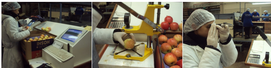
Figura 9. Mesa de controle de qualidade das maçãs na classificação e embalagem: Classificação das maçãs (A), Análise de Firmeza da polpa (B) e Análise de Sólidos Solúveis Totais - SST (C). Fonte: Tatiane C. da Silva, 2012.
