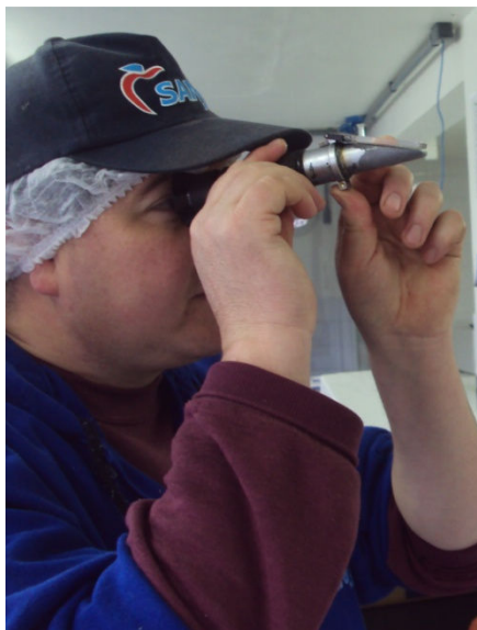
Figura 15. Refratômetro utilizado para medida sólidos solúveis totais (°Brix). Fonte: Tatiane C. da Silva, 2012.
