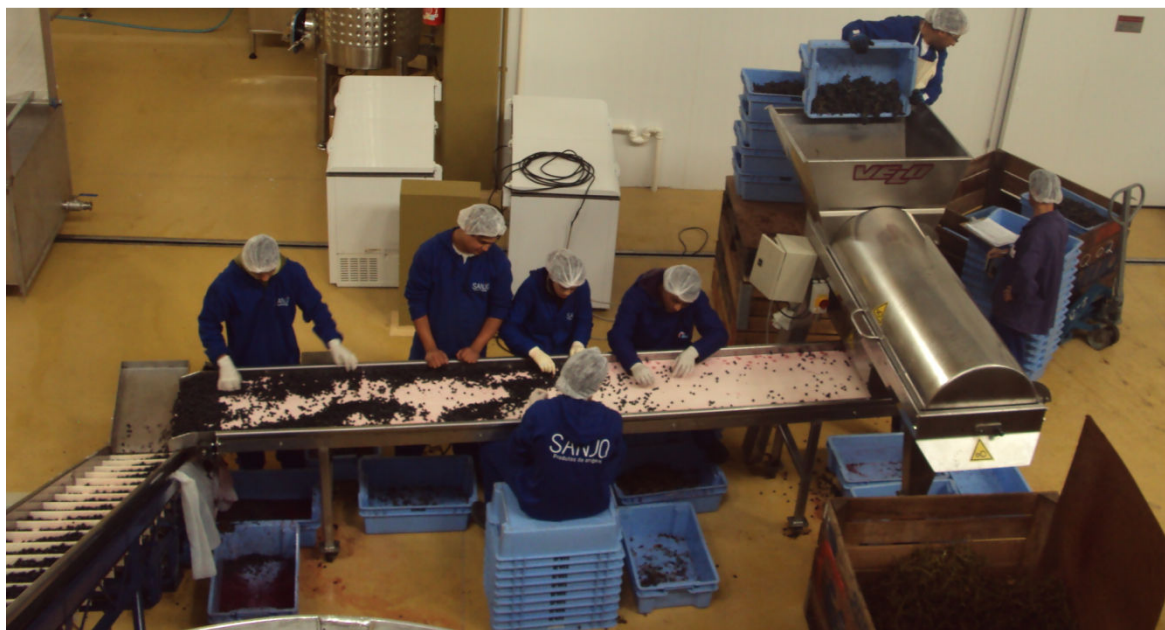
Figura 29. Processo de desengace, seleção e transporte das uvas para o tanque de fermentação. Fonte: Tatiane C. da Silva, 2012.
