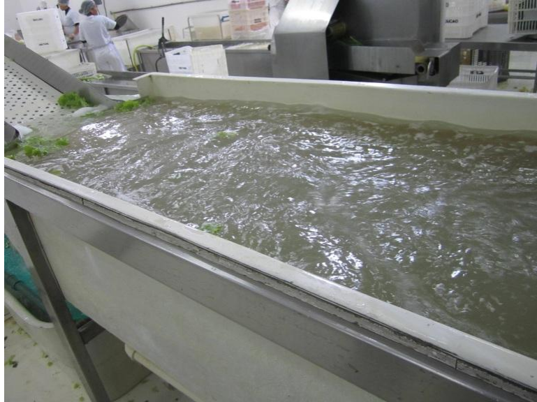
Figura 9- Etapa de enxágue em água gelada e circulante. Fonte: foto do autor.
