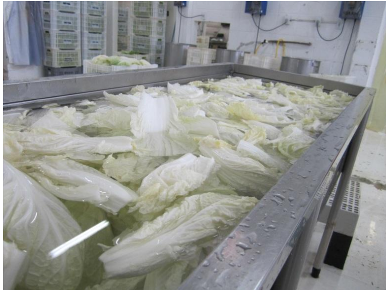
Figura 7- Lavagem de produto em água e solução de ácido cítrico. Fonte: foto do autor.
