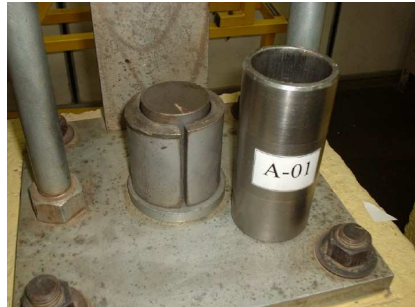
b - Detalhe da meia-cana para apoio do cilindro.
