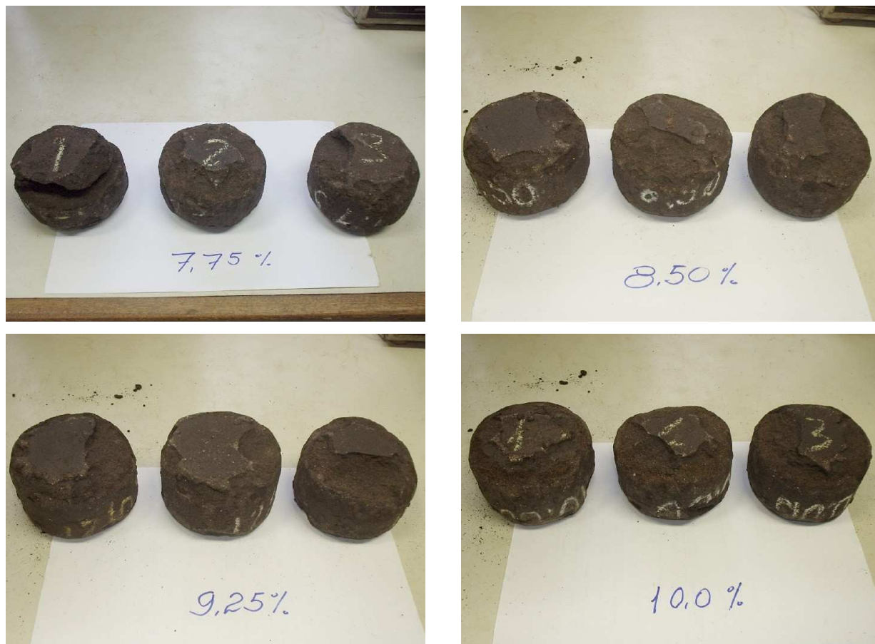
Figura 4.69 – Corpos de prova após o ensaio de cântabro.
