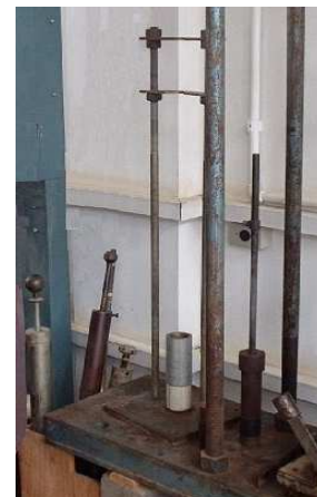
d - Equipamento para compactação da amostra.
