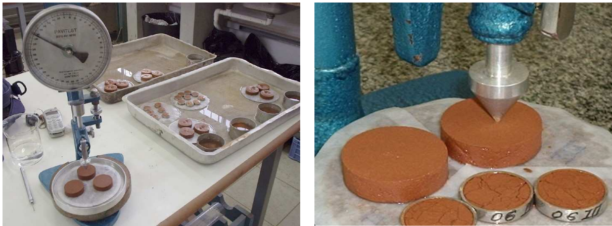
Figura 2.15 – Procedimentos para penetração na amostra
