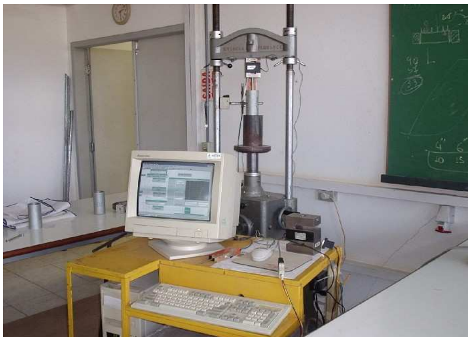
Figura 4.22 – Equipamento utilizado para a execução dos ensaios Mini Proctor.
