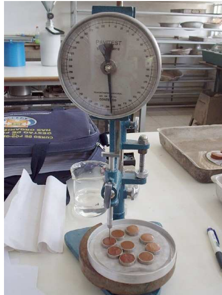
Figura 2.13 – Medição da penetração.
