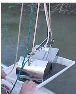
Figura 08. Amostrador pontual do tipo van Veen utilizado nas coletas de amostras de sedimentos.
