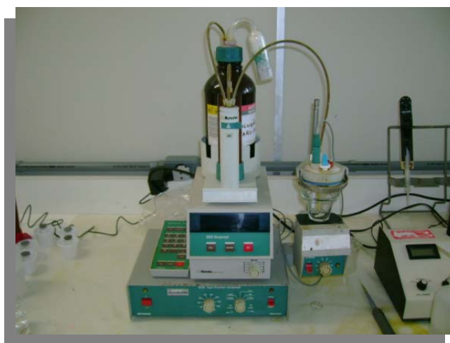
Figura 15. Titulador 633 Automático Karl Fischer, Metrohm AG CH-9100 Herisau.
