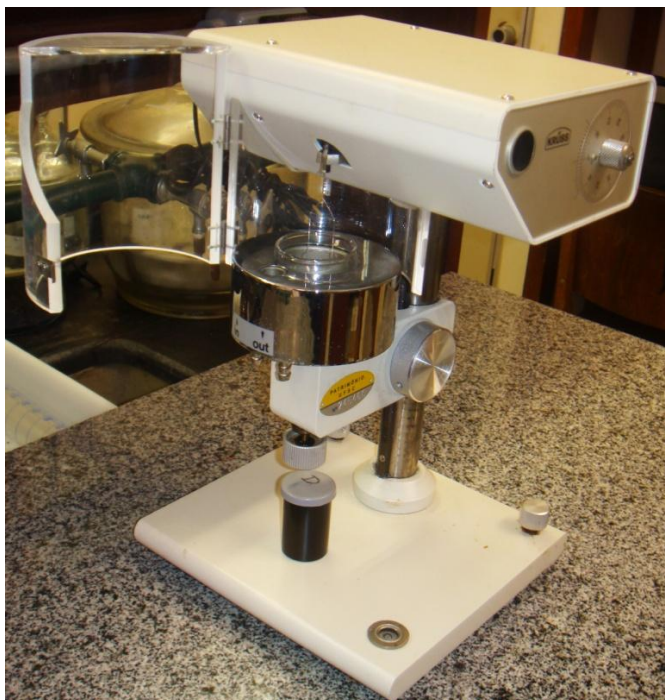
Figura 8. Tensiômetro de du Nouy, KRAUSS, proveniente do Laboratório 214, do Departamento de Química, UFSC.
