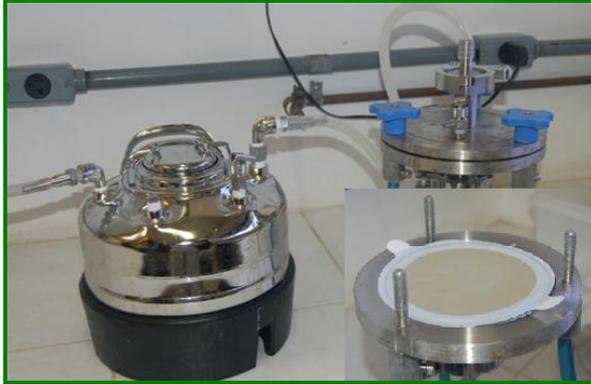
**Figura 9:** Sistema a vácuo de filtração, com capacidade para 5L de água, utilizado para a concentração viral; No canto direito inferior observa-se a membrana carregada eletronegativamente, responsável pela retenção das partículas virais.
