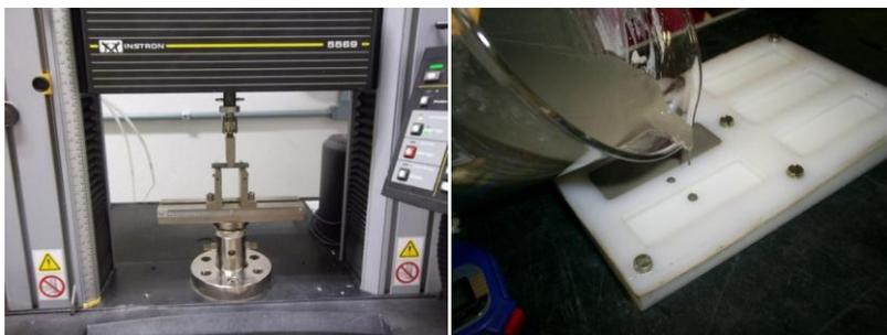
**Figura 77** Esquema de ensaios de resistência à flexão “A”, em “B” molde utilizado para a produção dos corpos de prova.
