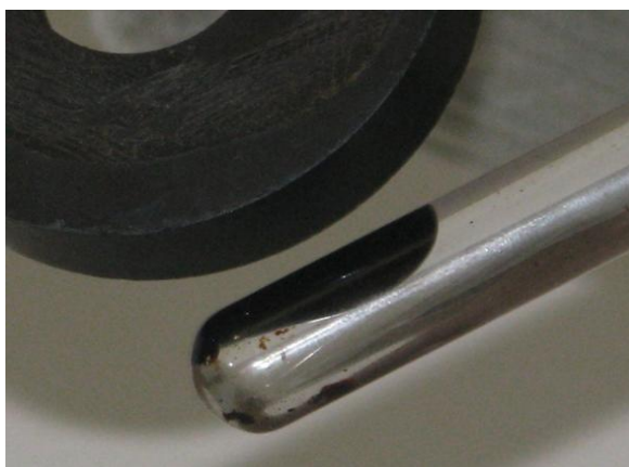
Figura 13: Resposta magnética da suspensão coloidal de NPsFe em tolueno a aproximação de um ímã.
