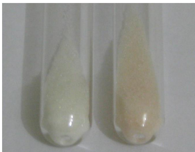
Figura 20: À esquerda fotografia das microesferas de sty-dvb, à direita microesferas de sty-dvb impregnadas com NPsAg.
