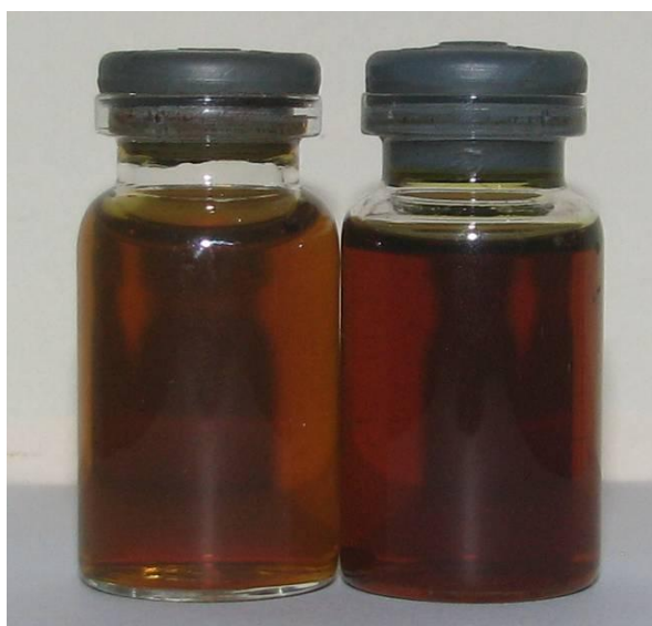
Figura 6: Fotografia das NPsAg em suspensão, à esquerda em meio aquoso, e à direita em meio orgânico.
