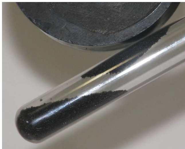
Figura 24: Fotografia das microesferas de sty-dvb impregnadas com NPsFe sob ação de um campo magnético.
