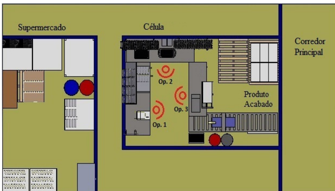
Figura 22 – Planta baixa com três operadores trabalhando na célula. Fonte: dados da empresa (2010).
