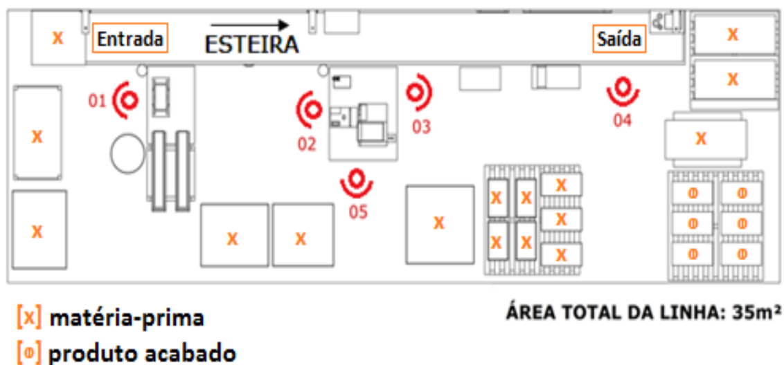
Figura 4 – Planta baixa da linha de montagem. Postos de trabalho numerados. Fonte: dados da empresa (2010).
