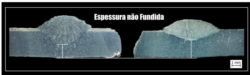
**Figura 2.33: Efeito negativo da camada aspergida sobre a penetração.**
