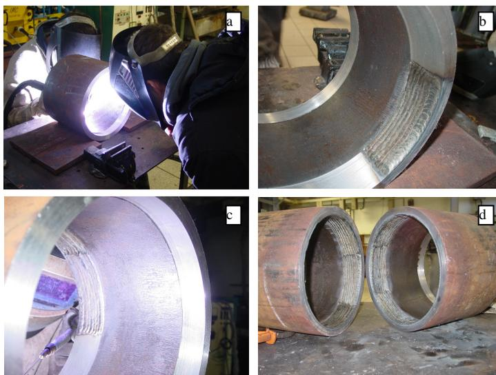
**Figura 2.7: Fabricação de revestimento por soldagem na extremidade de tubos através do processo GTAW automático com controle adaptativo.**
