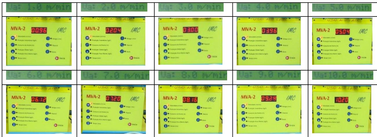
Figura 3.8: Verificação da calibração do sistema de alimentação de arame.
