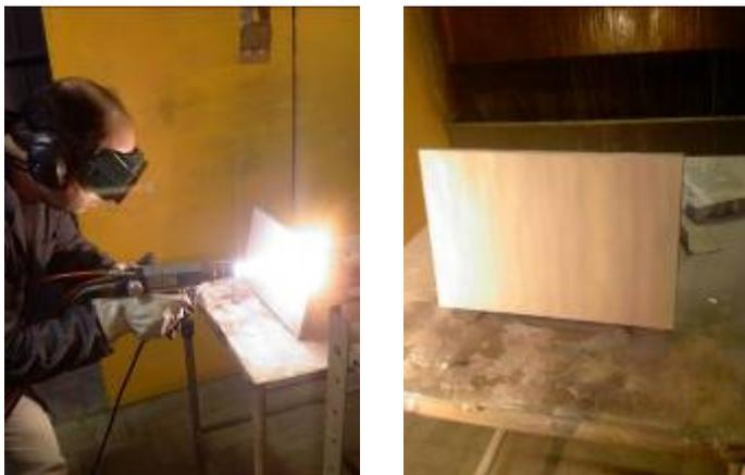
**Figura 4.25: Deposição da camada de níquel puro sobre chapa de aço C-Mn através do processo de aspersão térmica à chama.**
