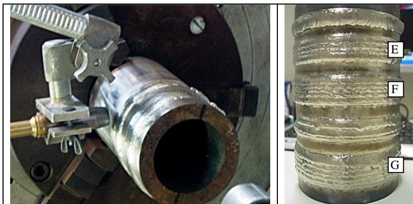
**Figura 4.57. Fabricação de revestimentos em tubos na posição vertical descendente.**
