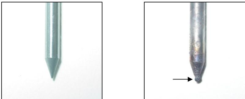
**Figura 4.28: Contaminação do eletrodo GTAW devido à refusão da camada aspergida.**
