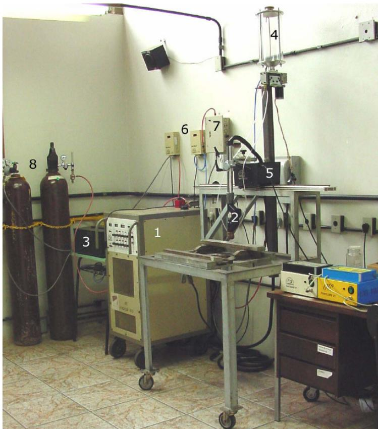
**Figura 2.18: Equipamento para soldagem plasma-pó – PTAP. 1-Fonte de soldagem; 2-Tocha; 3-Modulo plasma; 4-Alimentador de pó; 5-Sistema de deslocamento da tocha; 6-Medidores digitais de gases; 7-Válvula eletrônica de gás; 8-gases. Fonte: DIAZ, (2005).**
