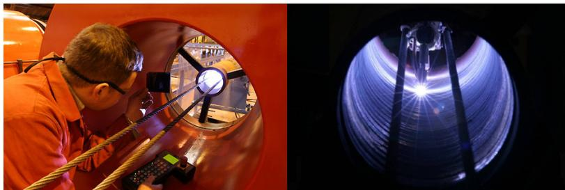
**Figura 2.8: Revestimento interno por soldagem GTAW “hot wire” com CNC.** Fonte: *IODS - Weld Cladding, Pipe Cladding, Clad Pipe Fittings and Fabrication, (2014).*
