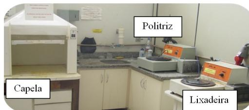
**Figura 3.14: Bancada de preparação metalográfica.**
