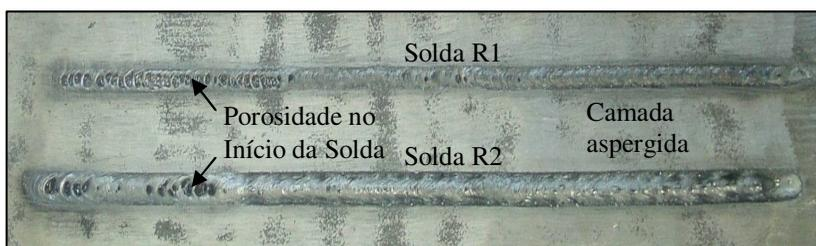
**Figura 4.27:** Refusão da camada termicamente aspergida de níquel puro sobre substrato de aço comum C-Mn através do processo de soldagem TIG.
