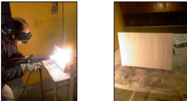
**Figura 3.13- Revestimento por aspersão térmica sobre chapa plana.**
