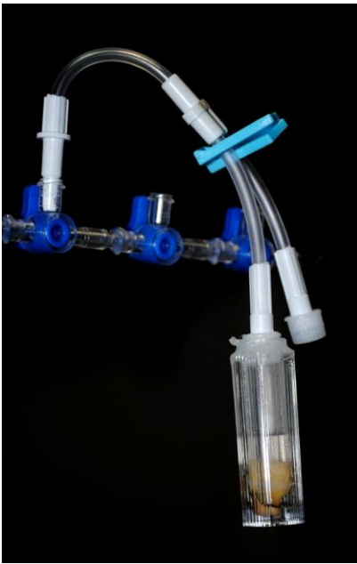
Figura 2 – Sistema de distribuição de pressão (A e B)
