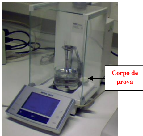
Figura 3.1 Determinação da massa do corpo de prova no ar.
