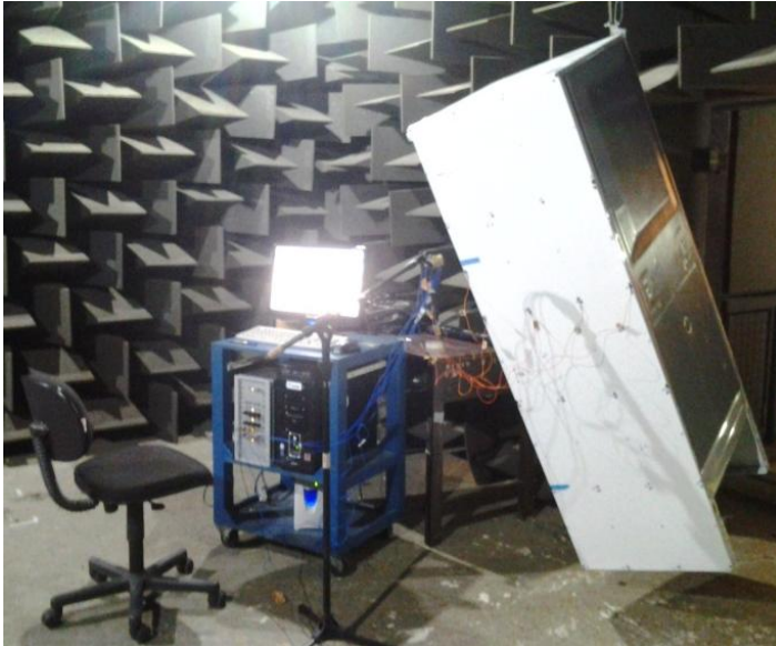
Figura 4.4 Análise modal experimental do refrigerador em condição livre.
