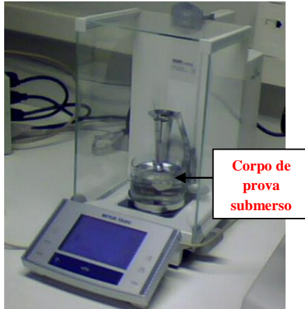
Figura 3.2 Determinação da massa aparente do corpo de prova.
