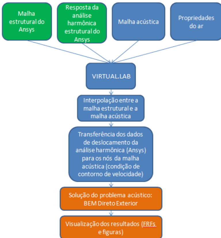
Figura 5.1 Descrição do procedimento para gerar modelo BEM.
