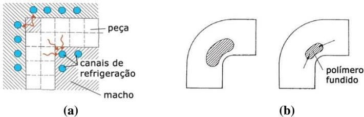
**Figura 29** - Solidificação do polímero fundido no canto da peça mostrando: (a) dificuldade de refrigeração no macho; e (b) polímero fundido remanescente.
