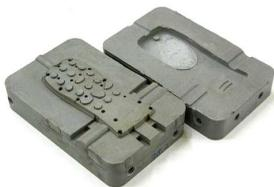
**Figura 7** – Molde protótipo VRE.
