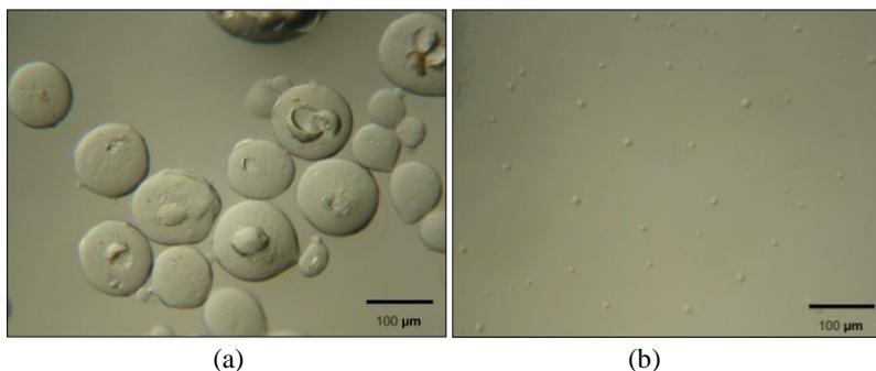
Figura 51 - Imagens das microcápsulas a 37°C no tampão suor básico pH 8,0 (a) no início do processo de liberação e (b) ao final do tempo de 10 min. Lente com aumento de 100x.
