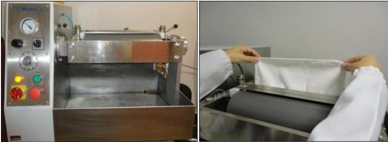
Figura 38 - Forno termofixador utilizado para a secagem das amostras tratadas
