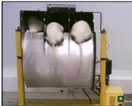
Figura 3.2: Aparelho para avaliação da incapacitação articular. Um cilindro em rotação constante permite a deambulação dos ratos e o registro do tempo de TEP, ou seja, a medida da incapacitação articular.
