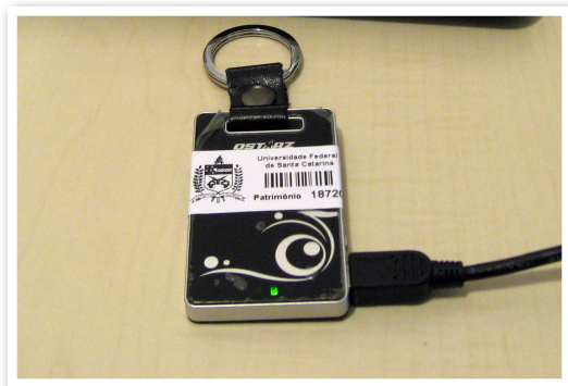
Figura 29: GPS USB responsável por fornecer as coordenadas geográficas.
