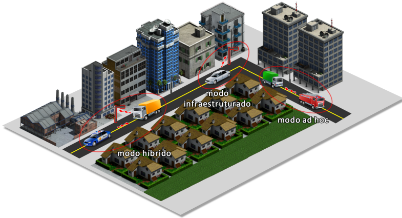
Figura 3: Esquema ilustrativo das arquiteturas de redes veiculares.
