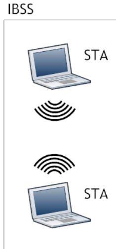
Figura 7: Arquitetura IBSS - Independent Basic Service Set do IEEE 802.11: rede sem fio formada por pelo menos duas estações.
