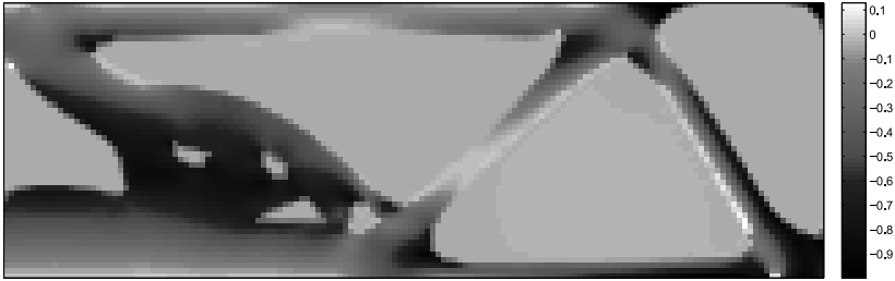
Figura 4.16: Viga bi-apoiada sob carregamento transversal central (MBB). Campo de funções de falha \varepsilon -relaxadas.
