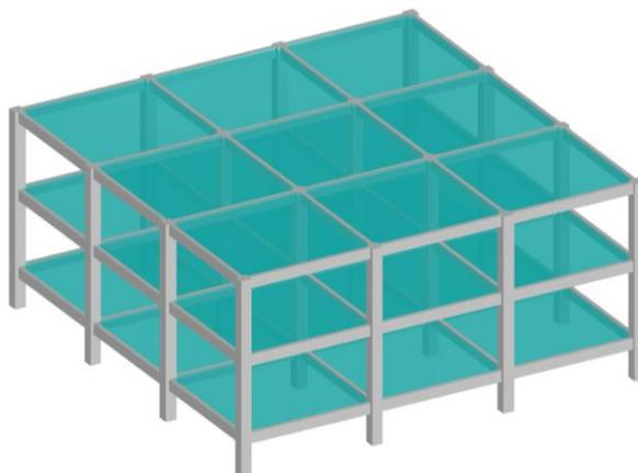
Figura 101 - Exemplo 2 – Modelo com 3 elevações para aplicação do espectro de resposta de projeto da NBR 15421:2006
