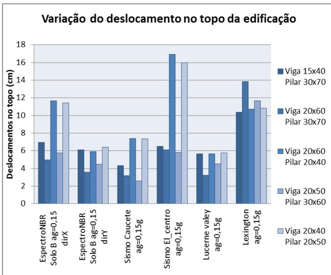
Figura 119 - Resultados de deslocamento no topo da edificação para diferentes rigidezes e métodos de análise – Modelo 3 com 5 pavimentos
