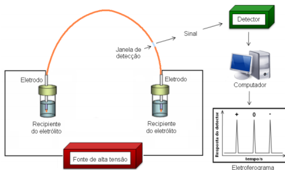
Figura 1.1 – Representação esquemática da instrumentação de eletroforese capilar.
