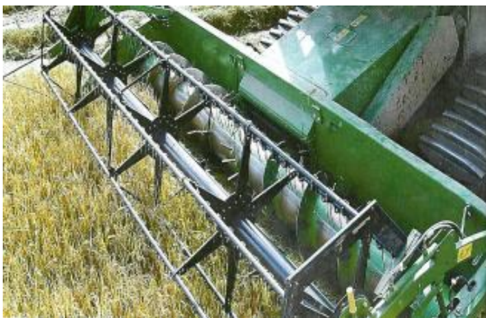
Figura 35: Ceifadeira: máquina utilizada na realização do corte do arroz.
