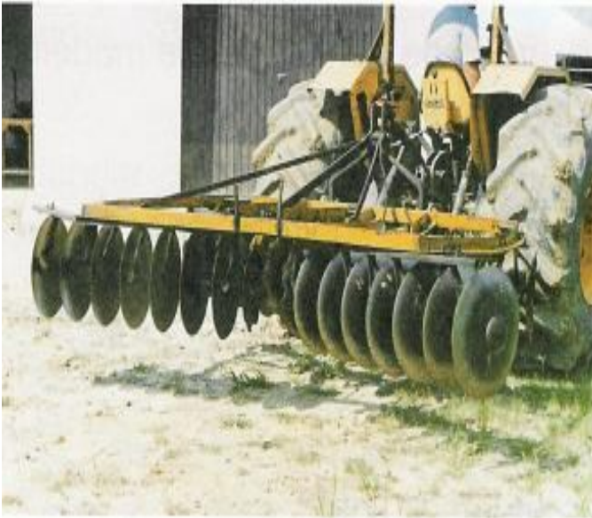
Figura 30: Trator com grade usada no destorroamento, eliminação de plantas daninhas e formação da lama.
