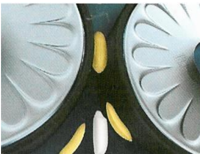
Figura 20: Processo de Polimento dos grãos de arroz a jato d' água.
