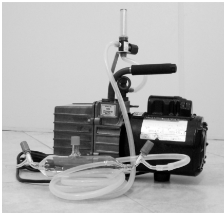
Figura 60 – Sistema de coleta montado para coletas em campo.
