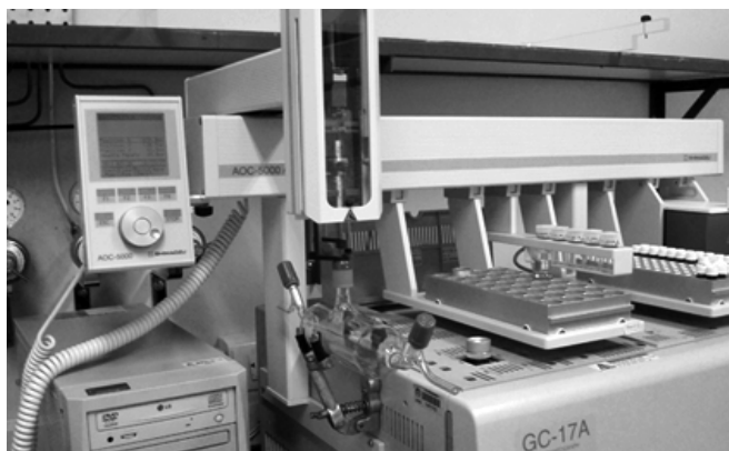
Figura 24 – Adaptação do auto-injetor para adição de padrões nas ampolas de coleta de gases.
