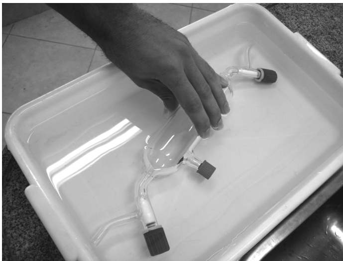
Figura 23 – Teste de submersão para verificação da estanqueidade das ampolas.
